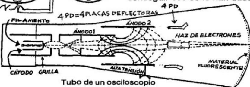
Tubo de un oscilloscopio
